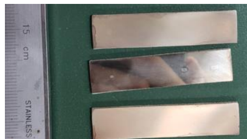
図 4 サイクル熱処理による作製したバルク単結晶。
