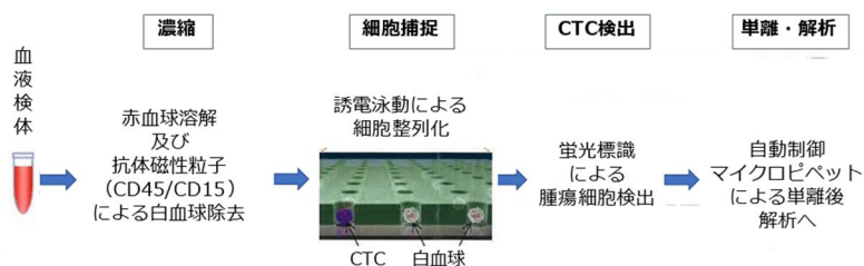
図2: 誘電泳動法によるCTC単離解析技術
