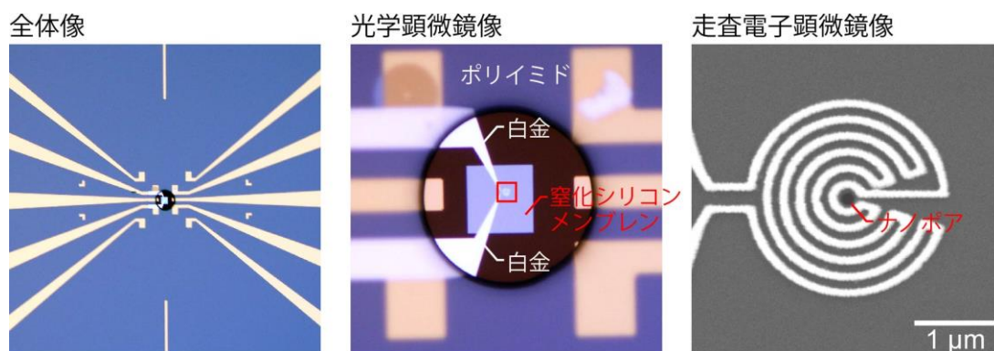
図 1. 白金ナノワイヤヒータとナノポアの集積構造.ナノワイヤを通電加熱させてナノポア近傍の温度を昇温させる.
