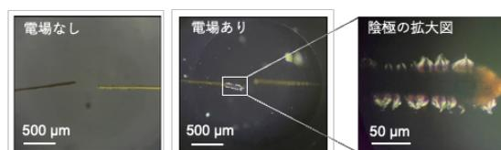
以上の結果から、正の電荷を帯びているイミダゾリウムカチオンを有するモノマーは、電界中で電気泳動により電極近傍に供給され、電場に沿って超分子ポリマーが成長したのではないかと考察した。本研究で得られた知見によって、イオン性モノマーが電界中において超分子ポリマーを形成する可能性を示すことができた。今後、本助成にて立ち上げた装置系や条件を発展させ詳細に手法の検討を行うとともに得られた集合体の解析を進める。また、モデル化合物に加えて、分子形状の似た電子供与性・受容性の骨格をもつ分子への展開も検討し、この制御方法に汎用性があるかを明らかにしていきたい。
