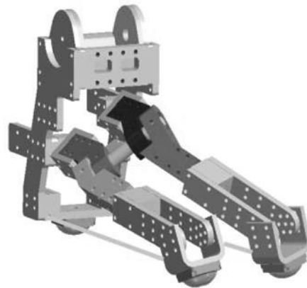
図7 試作された,傾いた中足骨関節の回転軸を持つ足部
