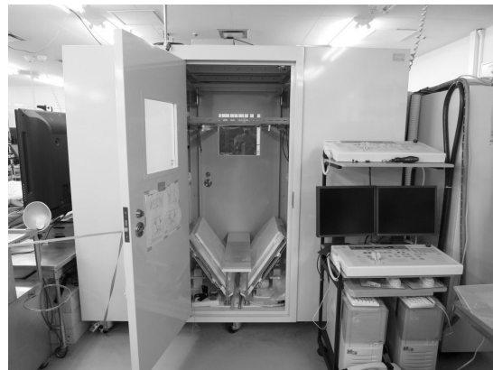
図3 二方向エックス線透過装置。内部には二つの線源と、フラットパネルディテクタ二枚が装備されている。
