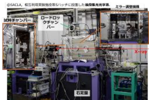
図6 SACLA に設置した Sub-10nm 集光システムの外観およびミラー調節機構と試料チャンパー内部
