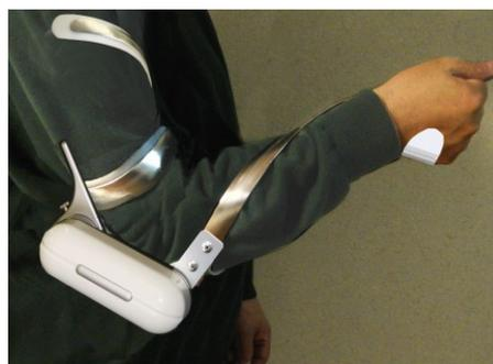
図3 振戦抑制ロボット
