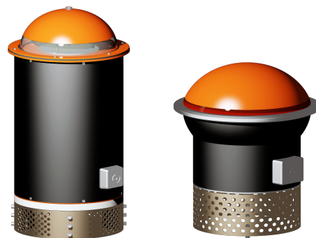
図2 本事業で設計製作した現場型二酸化炭素分圧測定装置(左)と地球観測システム構築推進プランで設計製作した装置(右)
