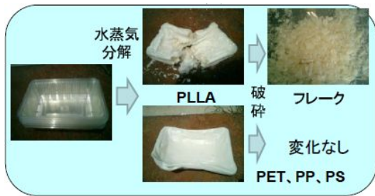
図2．過熱水蒸気によるポリ乳酸(PLLA)の分解
