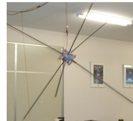
図5: 開発した自己伸展電界センサー。
