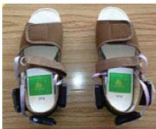
(a) 履物内蔵型センサシステムの概観
