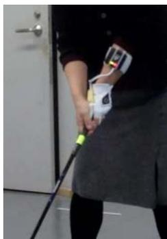
図 12 プレーヤに取り付けた慣性センサ
