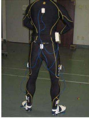
図4 ウェアラブル運動解析システム
