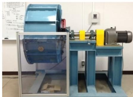
写真1 開発したドラム式流動試験装置
