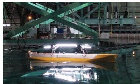
図4 コンテナ船模型を用いた波浪中速力試験
