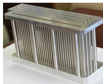
図2 PANTA 用に製作されたトモグラフィー用光検出器。ArI および ArII ラインを検出可能
