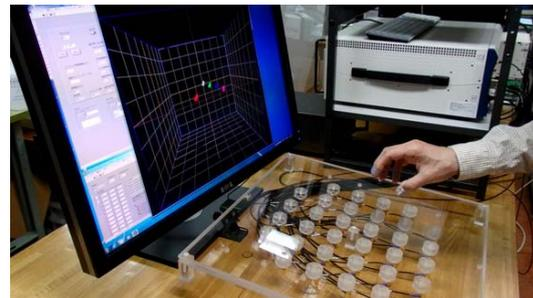
図6 指に添付した 5 個の磁気マーカーのモーションキャプチャの様子 (検出速度: 約 50Hz)
