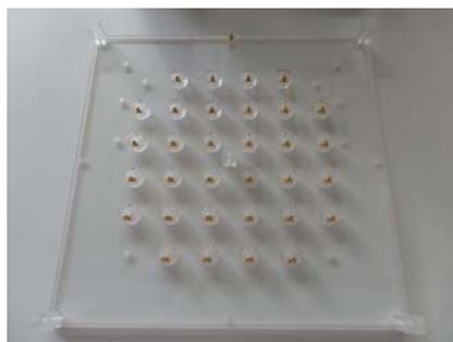
図3 32chに拡張した検出コイルアレイ、およびフレーム外周に一体化された励磁コイルアレイ
