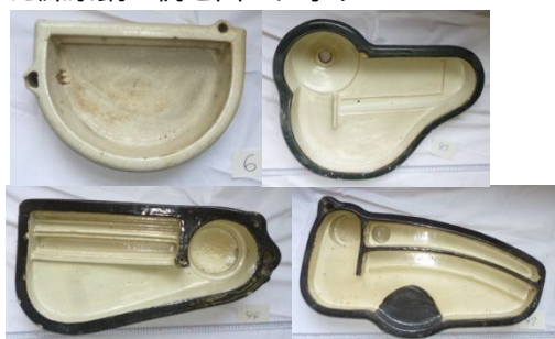
図4 繰糸鍋の形状例(岡谷蚕糸博物館蔵)
