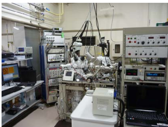
図 1 開発した四探針 STM-PEEM 複合装置。写真右側が今回開発した PEEM を有する有機薄膜成長装置であり、左側の STM 装置との間で試料の交換及び顕微鏡観察が可能。
