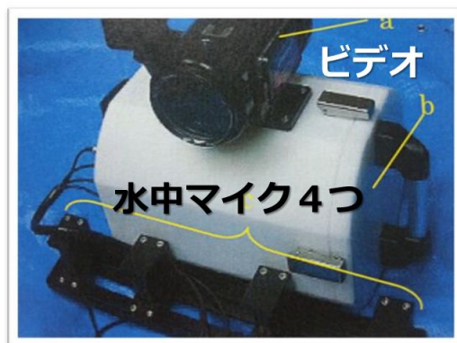
図4 イルカの鳴音を正確に取得するためのシステム (2012年、初期バージョン)
