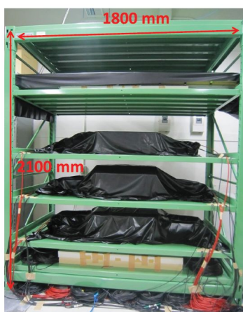
図 2：プロトタイプ検出器（82kg）の全体セットアップ
