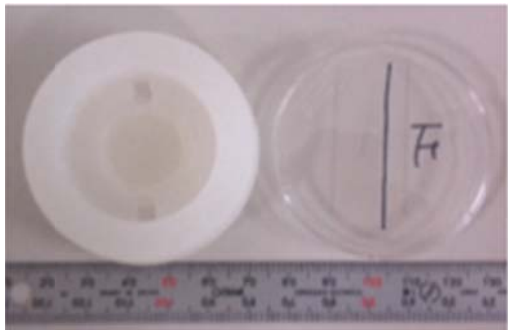
図1 摺動負荷培養実験用培養皿と内部に作成された生体組織モデル
