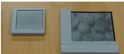
図 6 単一マイコン駆動低消費電力電子ペーパー
