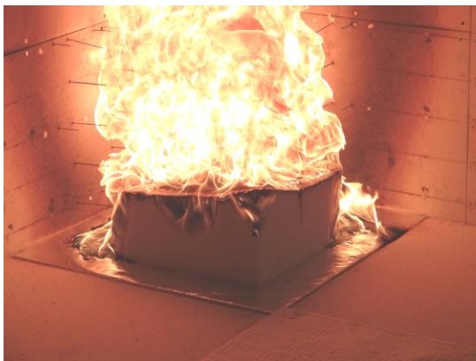
図 2 室の隅角部近傍におけるウレタンブロックの燃焼性状
