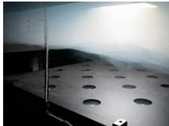
図 4 白煙による散乱光測定の実況
