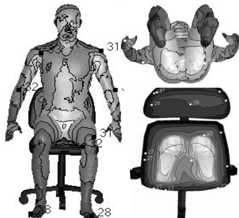
図4 表面温度分布の解析結果
