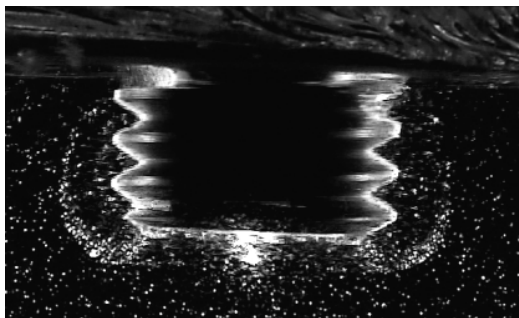
図3 透明作動流体を用いた摩擦攪拌スポット接合の流動観察結果
