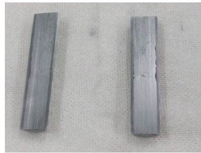
図 1 温度勾配法で作製した InGaSb 結晶の一例
