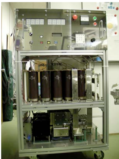
図3 波形制御パルス着磁電源装置
