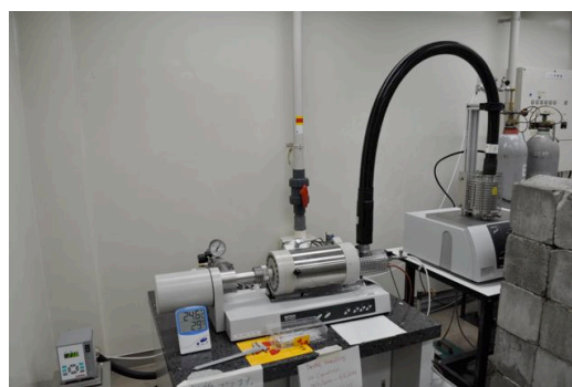
図 1 精密熱膨張計—質量分析複合装置
