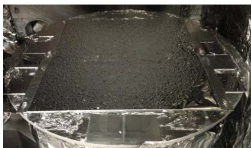
図6 レプリカ法で m=3 NiC/Ti スーパーミラーに \text{Ti} 10\mu\text{m} を製膜した写真(KUR-IBS チャンバー内)。Ti の応力によりぼこぼこ浮き上がり全く平坦になっていない。
