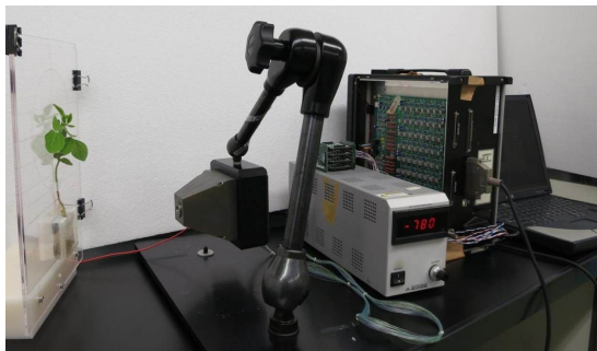
図 2 植物用ガンマカメラ試作機
