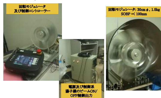
図6：開発した回転型レンジモジュレーターホイールシステムの写真。
