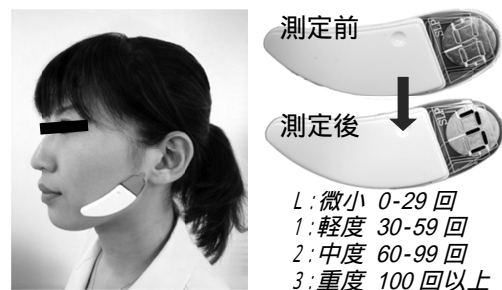
図1. 簡易型睡眠時ブラキシズム診断装置 BiteStrip®. 左側咬筋上に双電極が位置するように貼付し、5時間の夜間咬筋筋活動測定を行う。結果は、覚醒時の最大噛みしめにおける筋活動量の30%を閾値としたときのブラキシズムイベント頻度に応じて、ディスプレイ部にL・1・2・3の4段階で表示される。
