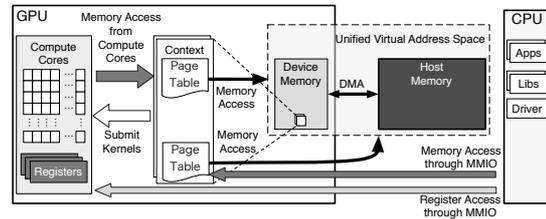
上の図は GPU のハードウェア上の構成を外観したものである。ホスト CPU が GPU とやりとりする MMIO (memory-mapped I/O) の仮想化、GPU チャンネルの仮想化、GPU ページテーブルの仮想化などを行い、GPU の仮想化を達成した。このアーキテクチャを下図に示す。
