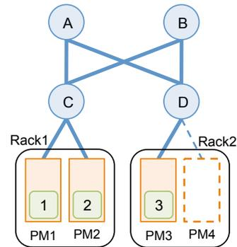
この状態で仮想マシン 3 を Rack1 にある物理マシンに移送を行うと下の図のようになり、ネットワークスイッチ D を停止できる。
