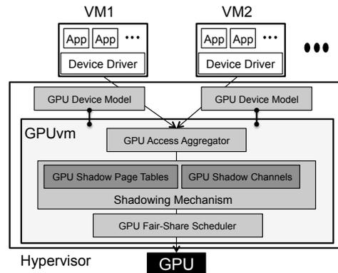
GPU Access Aggregator というモジュールによって GPU に対するコマンドリクエストがスケジューリングされるため、その部分に省電力化のための GPU スケジューリング機構を組み込むことが可能な仕組みとなっている。
