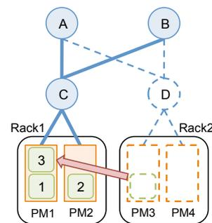
提案方式ではネットワーク・スイッチ A, B の空きポートを利用し、その空きポートからそれぞれ PM1, PM3 へのバイパスとなるネットワークを敷設する。このようにすることで、同じ状況においてもさらにネットワーク機
