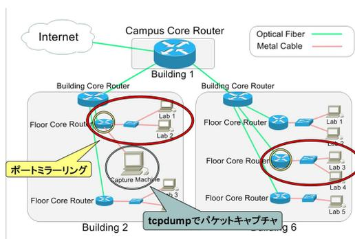
神奈川大学平塚キャンパスにおいて、上図のようにパケットキャプチャを行い、個人情報などを含むペイロードを削除した後に同様の方法で遅延を計測した。
