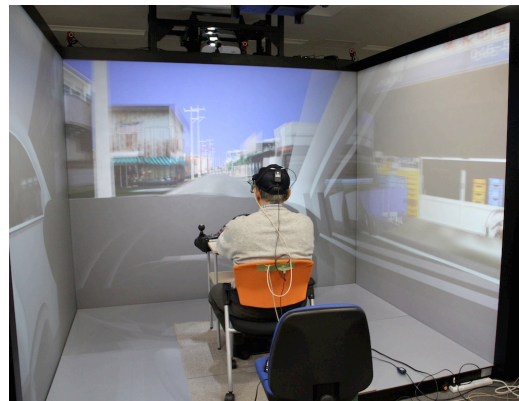
図 3: 没入ドライビングシミュレータによる高齢ドライバーの運転行動観察実験の様子
