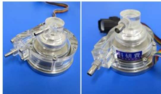
図4. 試作遠心ポンプ DP2 左および DP3 右
