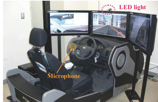
図2 開発した運転シミュレータ
