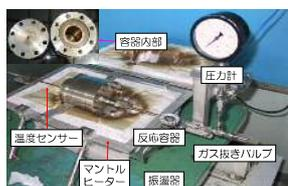
図 4 亜臨界水熱反応装置
