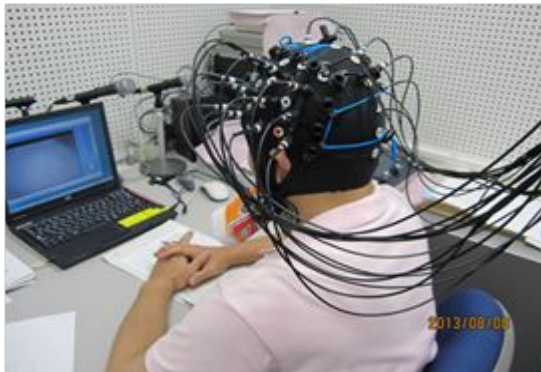
図 1. OMM-3000 で被験者が、側頭葉の血流を計測するためにプローブを装着し実験を行っている様子
