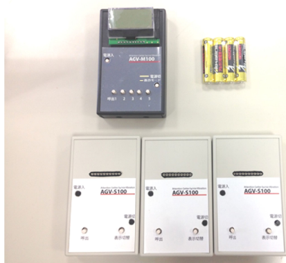
図1：注意喚起システム（実験者が操作する親機：上、被験者が保持する子機：下）小電力無線データ通信方式（ZigBee 規格）を利用した情報伝達システムで、親機のスイッチ操作により、すべての子機があらかじめ設定された時間（秒）振動する。
