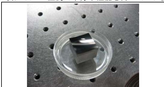
図 3：切削加工で試作した球面鏡。
