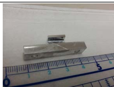
図 5：切削加工によるイメージスライサの試作品。
