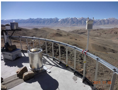
図 3. ガー山 (5032m) サイト調査用 10m タワー屋上に設置された中間赤外線カメラ雲モニター装置(円形チューブ)と気象観測機器(右側手摺上)。左側 2 台のカメラは中国国家天文台による可視光全天カメラ。
