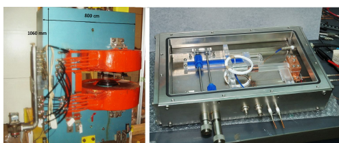
図 3：導入した電磁石と真空チェンバー
