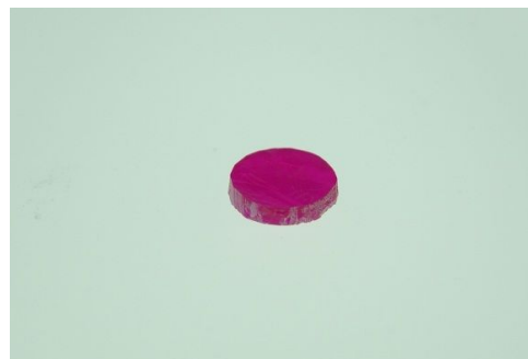
図 1 : ペンタセンをドーブした p-タフェニル結晶
