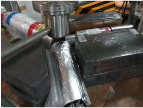
図2 KUR-ISOLでの \beta - \gamma - \gamma 同時計数測定の様子。手前がプラスチックシンチレータ。右奥が \text{LaBr}_3 シンチレータ。
