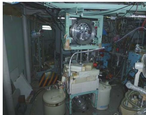
図 1 KUR-ISOL での \gamma - \gamma 同時計数実験の様子。右奥に見える電磁石で測定対象核を質量分離し、その核から放出される \gamma 線を 2 台の Ge 検出器で測定した。
