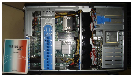
図：開発用の GPGPU ワークステーション CPU：Intel Xeon X5650 2.67GHz (6 cores) GPU：Nvidia Tesla C2075 1.15GHz (448 cores) 本研究の2年目にさらに GPU を増設、計3基の GPU を用いた。 OS：Scientific Linux ver.2.6
