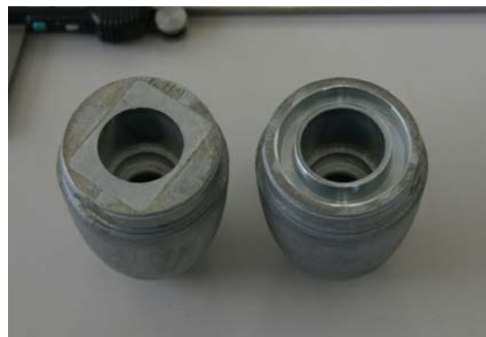
図 2 軽量化の方法。左が通常の製品、右が錘の内部を削り抜いて軽量化したもの。
