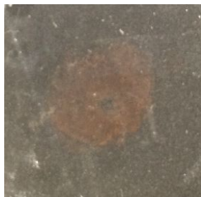
図3 ガラス表面に形成された金ナノ粒子-ポリアミド複合体(赤色部分)
