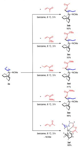
またナフタレンは6電子配位子であるが、ナフタレンの解離に伴い、4電子配位子となる 共役ジエンと2電子配位子となるアルケン を選択的に反応させることが可能である。例 えば共役ジエンとアセトニトリルが配位し た錯体に置換アルケンを反応させると1,3-ブタジエンと置換アルケンとのカップリン グ生成物が配位した0価錯体が概ね高収率 で得られた(スキーム1)。
