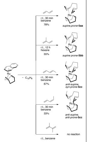
ナフタレンの解離に伴い、共役ジエンの 2 分子カップリングが進行し、ビス  $(\pi$ -アリル)ルテニウム錯体が生成する。これらの反応は常に立体選択的に進行し、常に supine, prone型、すなわち 2 つの $\pi$  アリル基の 1 つは(図上では)上方向にオープンな配向をとり、もう 1 つのアリル基は下方向にオープンな配向である。
