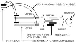
図 1 真核生物ゲノムの二倍体染色体機構に みられる情報分散システムを模倣した論理 判断機構の概念図 .DNA(1)と DNA(2)とは同 一遺伝子をコードしているが、遺伝子の上流 および下流に設けられているプライマー DNA 会合領域の配列は異なる.反応系に入 力されるプライマーDNA の組み合わせを変 えることによって, DNA(1)のみ, DNA(2)の み ,DNA(1)と DNA(2)の両者からの増幅反応 , のいずれかを誘起することができる. 増幅反 応に続いて無細胞蛋白質合成系による GFP 合成反応が行われ,その結果は蛍光発光の有 無によって確認することができる.プライマ -DNA をあらかじめ反応系に共存させてお き,これらのプライマーDNA と会合する配 列を持った一本鎖 DNA を入力信号とすれば, デフォルトで反応を進行させておく系を構 築することもできる.
