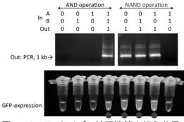
図 3 NAND タイプの論理演算を行う分子システムの出力 . 左側半分が比較のために掲載した AND タイプの演算 , 右側半分が本研究課題で開発に取り組んだ NAND タイプの演算 . 上段「AND operation」は 0 と 1 で入力と出力の関係を表したもの .中断は PCR における DNA 増幅が起きるか起きないかをアガロースゲル電気泳動で示したもの .「Out: PCR, 1 kb 」の位置がターゲット配列の増幅産物に対応する . 下段「GFP-expression」は増幅反応後の反応溶液を無細胞蛋白質合成系に混合した後に励起光照射を行った場合 . を付した4チューブで有意に蛍光が認められる .
