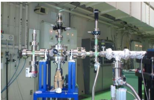
写真 1 BL7B に接続された VUV エリプソ試作機
