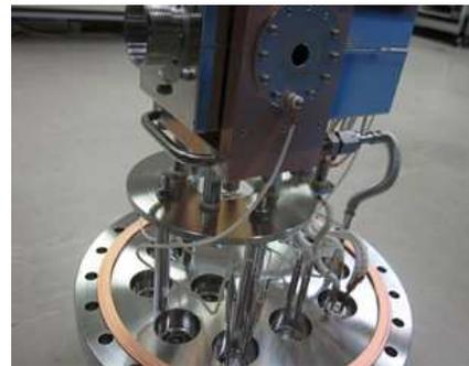
図 5 電荷交換室内部の外観
