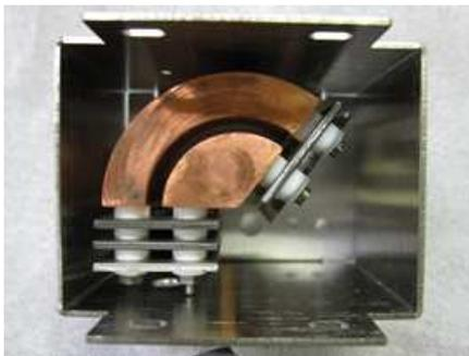
図 4 円筒共軸型のアナライザの様子
