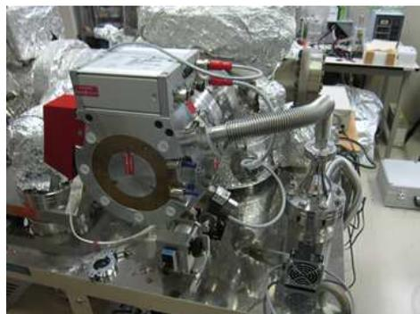
図1 実験装置の排気系外観
